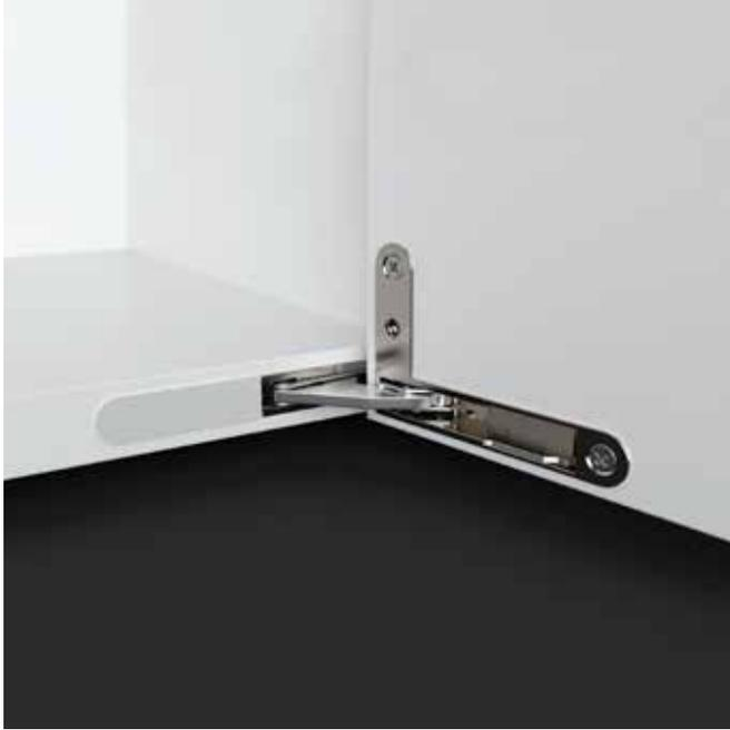
Cerniera a scomparsa con ammortizzatore incorporato per ante con telaio in alluminio o legno. Si applicano nel cappello e nella base del mobile. Compatibile con ante in legno e il telaio in alluminio art.PR30.
